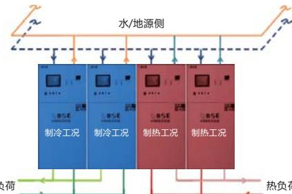
智磁™ ( I-CHILLER™ ) 系列磁悬浮无油变频离心式热泵模块机组可以进行有效的组合，冷热结合运行。当部分机组制冷运行，部分机组制热运行的时候，负荷侧各不影响，而水/地源侧冷热相互中和，有利于提升所有机组的效率，提升系统整体能效。
