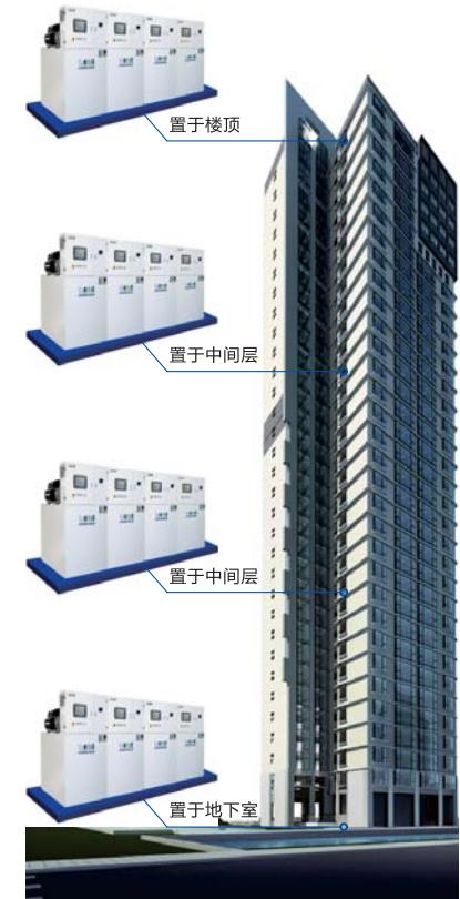
必信智磁™ ( I-CHILLER™ ) 系列磁悬浮无油变频离心式冷水/热泵模块机组尺寸小，重量轻，在超高层建筑中可以将机组放置在地下室、中间层设备间或者屋顶设备间，帮助整个建筑顺利完成垂直分区，降低管道承压问题，节省投资成本，同时，智磁™系列机组可以通过电梯垂直运输到所需楼层，高区机房的机组替换问题也迎刃而解。
