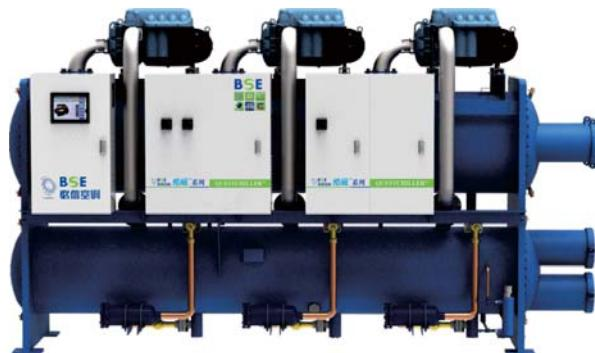
Q3系列超高效机组：冷水机组结构为单筒多机头的满液式设计，效率超高，全系所有产品满载COP均超过6.3，部分负荷效率IPLV更是高达14.0以上。特别适用于高温高载荷地区以及对于冷水机组效率要求高的项目。
